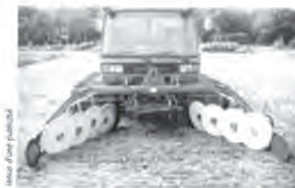
Matériel chenillé Kässbohrer équipé d'une faucheuse à section.
