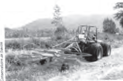
Fanage de blache à l'aide d'un tracteur à pneus basse pression.
