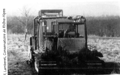
Utilisation d'un matériel chenillé pour les sols peu portants
