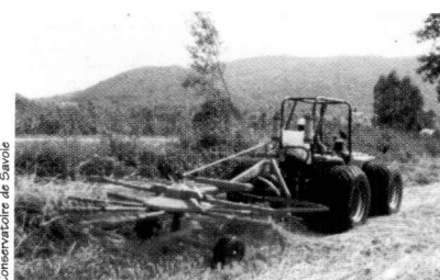
Matériel spécialisé à pneus basse pression
