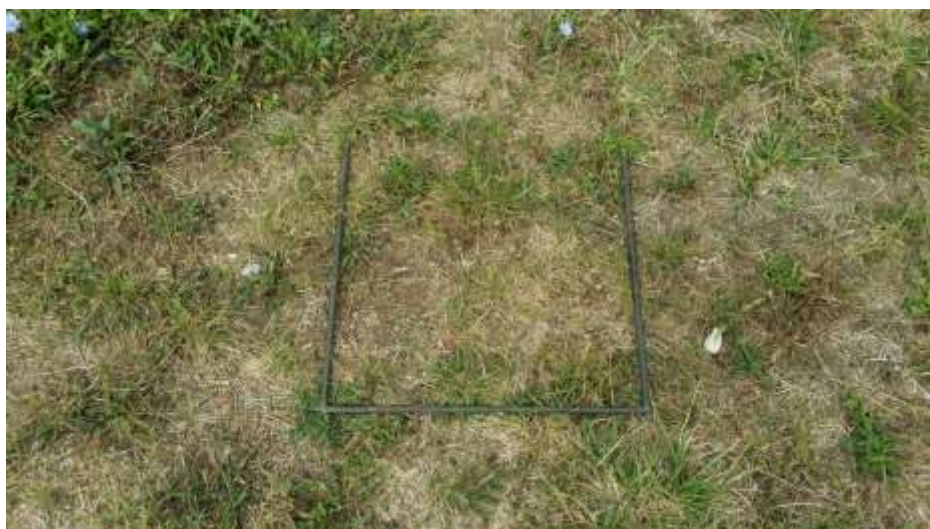
Figure 3 : Quadrat de 50 cm pour les mesures de biomasse
