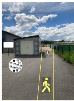
Panneau explicatif à côté du local technique + zone d'arrêt (traces de pieds) + socle fixe sur le local technique pour poser les deux échantillons d'eau
