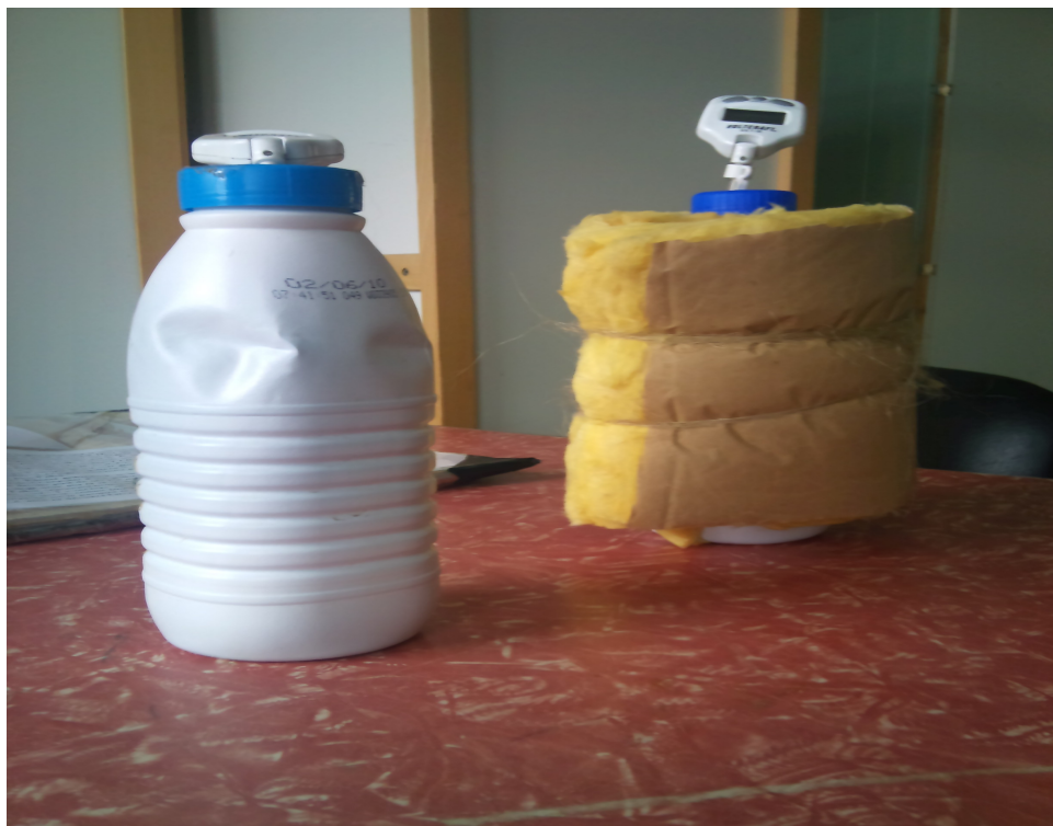
Illustration 8 : L'expérience avec les deux bouteilles de lait (à droite avec l'isolant en laine) (source: photo de Ginestou Bruno) (10)
