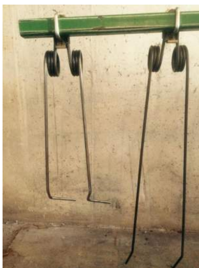
Figure 27 : Comparaison sur le changement des dents sur la barre d'envol de la FDC 36 (@Quentin BADER)
