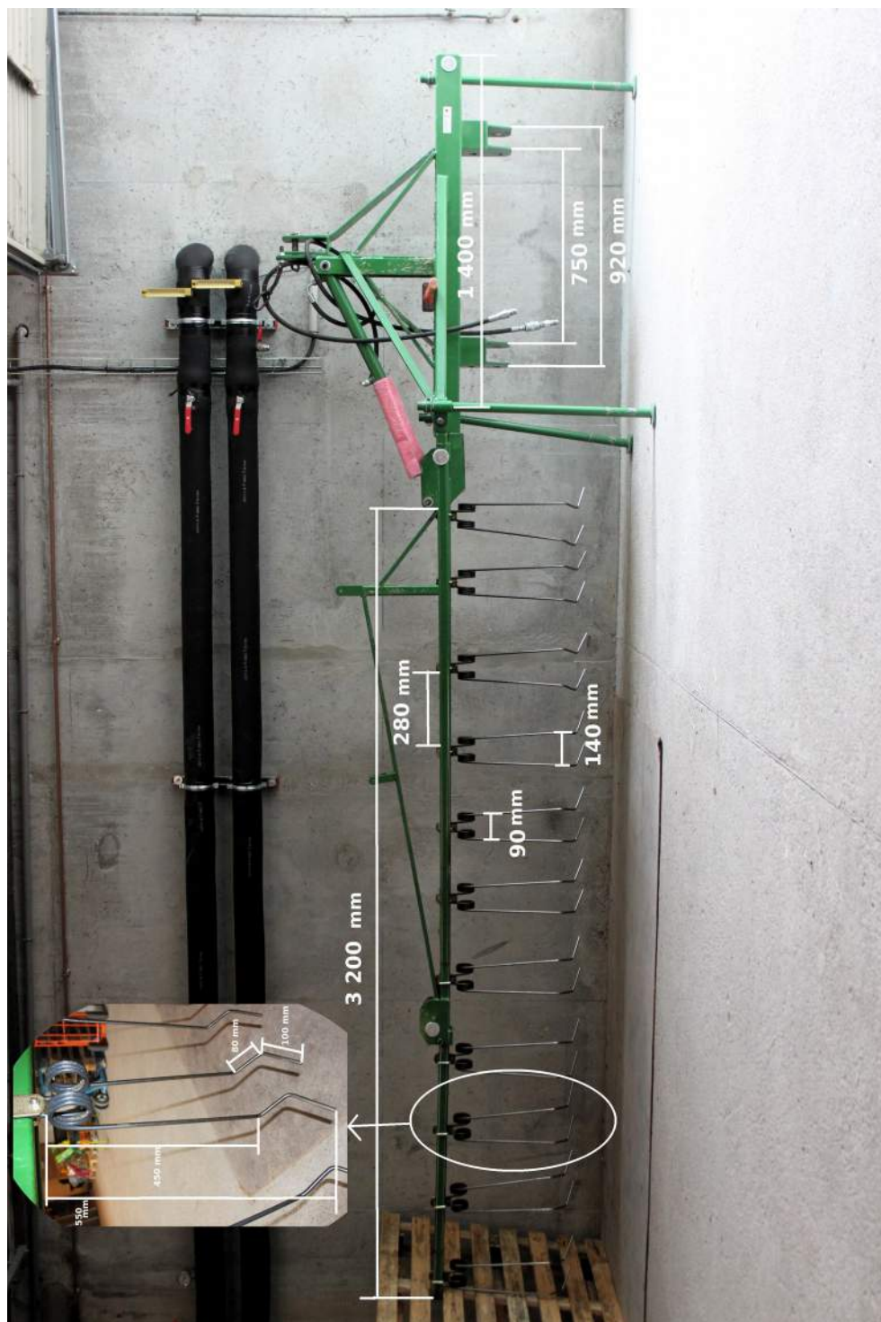
Figure 16 : Dimensions de la barre d'envol acquise par la FDC 36 (@Quentin BADER)
