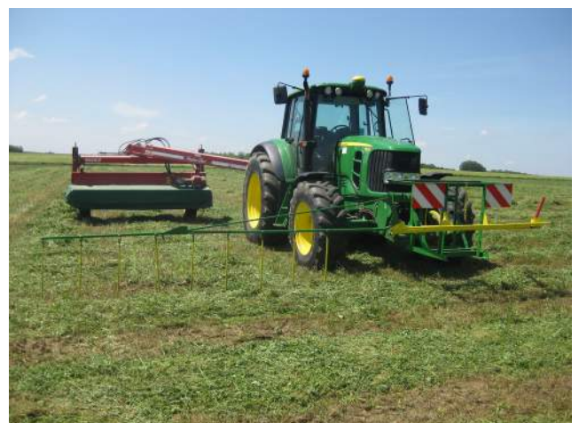
Figure 13 : Barre d'effarouchement à chaîne balayant (@Julien LECLER)
