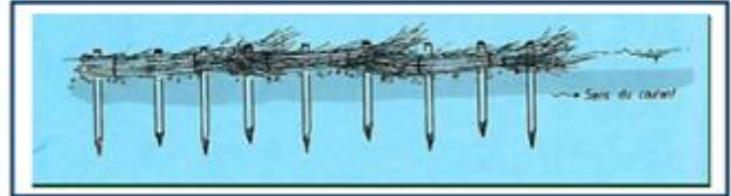
Figure 3 : Vue longitudinale d'une fascine
