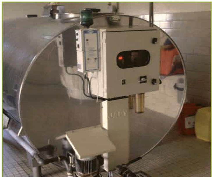
Photo 1 : Le tank à lait consomme en moyenne 200 kWh par vache / an
