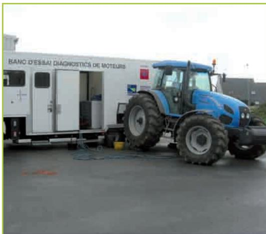
Photo 17 : Le réglage du moteur après passage au banc d'essai permet de réduire la consommation du tracteur
