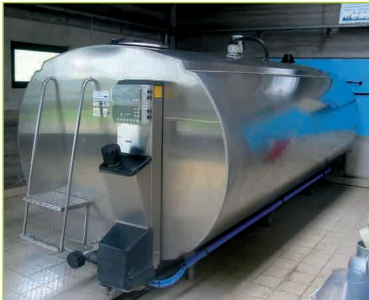
Photo 4 : La ventilation de la laiterie est essentielle pour limiter les consommations du tank
