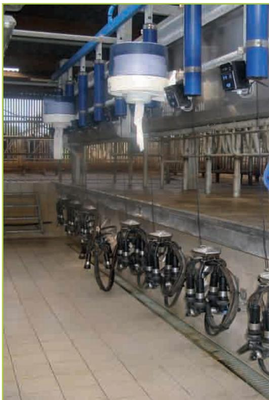
Photo 16 : La puissance de la pompe à vide doit être adaptée au nombre de postes
