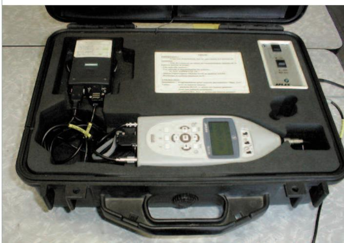
Le sonomètre est un système électronique constitué de filtres et d'amplificateurs. Il reçoit un signal électrique du microphone qu'il amplifie, filtre et traite, le résultat obtenu est généralement un ensemble de niveaux sonores pondérés A calculés chacun sur une durée dite d'intégration (souvent 125 ms ou 1s).
