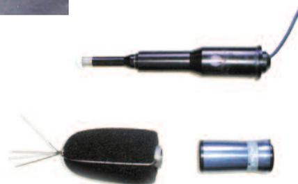
Les microphones utilisés en sonométrie classique sont omnidirectionnels, donc le microphone ne privilégie aucune direction source sonore/microphone ; il existe par ailleurs des microphones directionnels que l'on doit pointer sur la source sonore à observer.
