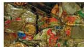
Compactage des emballages en aluminium
